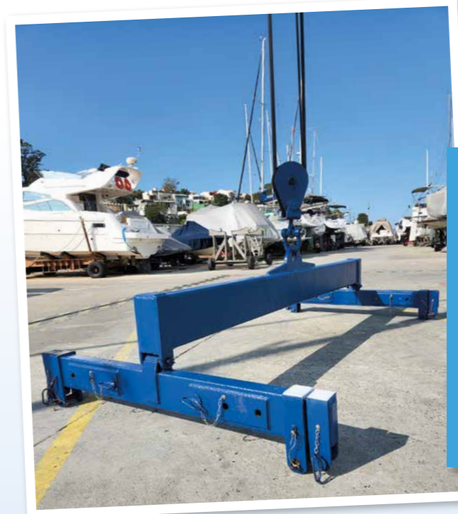
MANUTENÇÃO COMPLETA NO PAU DE CARGA (GUINCHO) COM TROCA DE CABOS, MANCAIS, FREIO-MOTOR VOLTANDO A SUA CAPACIDADE DE 15 T, INSTALADOS BRAÇO HIDRÁULICO E BALANÇA COM ALONGAMENTO TELESCÓPICO, MELHORANDO A OPERAÇÃO E O IÇAMENTO DE BARCOS MAIORES.
